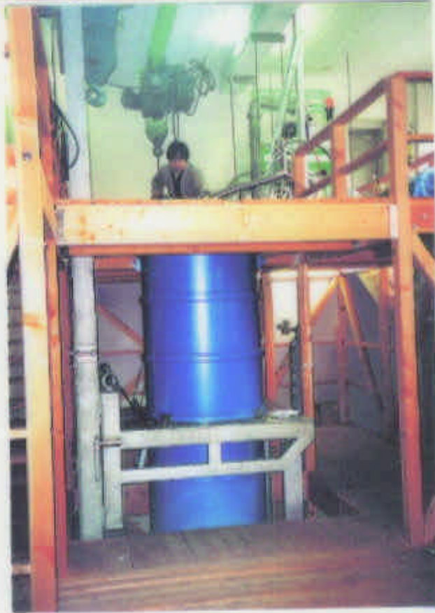
CARRACK 2 Axion 採集装置
